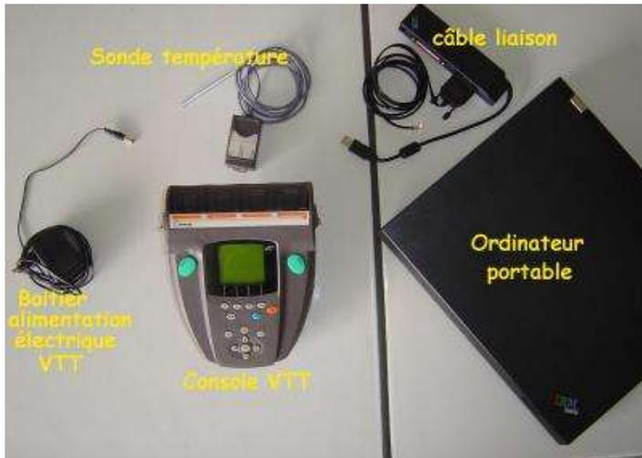
① Relier le capteur de température à la console
