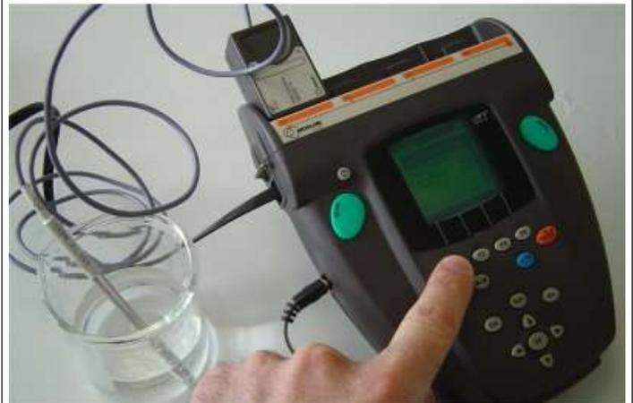
④ Placer la sonde de température dans le liquide. Attendre quelques secondes la stabilisation de la température.
