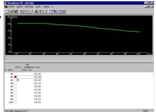
Possibilité de modifier le nom de la courbe, les noms des grandeurs et des unités sur les axes.
